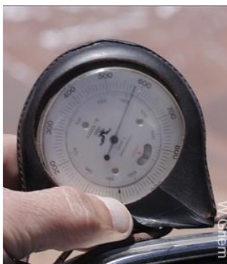
El altímetro barométrico - una herramienta útil, aunque actualmente los GPS o los celulares cumplen la misma función.
