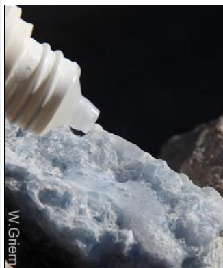
Reacción de ácido clorhídrico con carbonato de calcio - se ve y se escucha la reacción.
